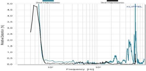
UNDERHUNG MOTOR DESIGN 55 MM TITANIUM VC FORMER SOFT RUBBER SURROUND VENTED VC, POLE PIECE & SPIDER 40 HZ - 3 KHZ IN VENTED BOX
