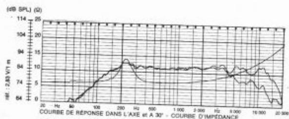
Haut-parleur de médium à cône de haute qualité équipé d'un saladier en magnésium injecté sous pression. Dérivé du MHD 12 P 25 FSM dont il reprend l'équipage mobile. Cette version est équipée d'un moteur moins puissant.
