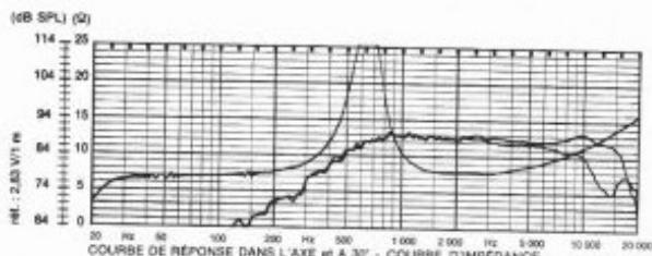
Membrane dôme souple à grande corrugation permettant de bonnes élongations nécessaires à la reproduction correcte du médium jusqu'à 700 Hz.
