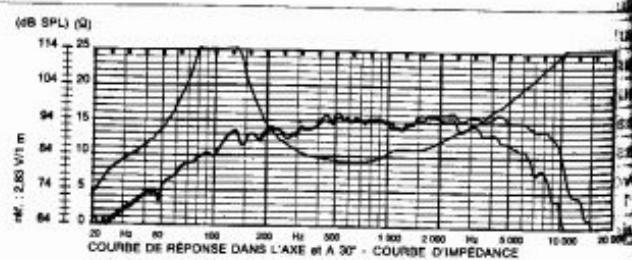
Haut-parleur de médium, très haute qualité. Sa membrane à profil exponentiel et suspension plane en mousse lui assure une coupure naturelle sans résonance en extrémité de bande. Haut rendement et puissance admissible importante.
