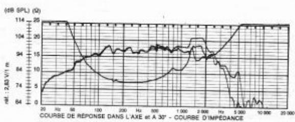
Haut-parleur de grave. Série professionnelle. Saclier Zemco injecté. Membrane spéciale pressée. Bobine mobile Ø 220 mm. Courant continu : 100 mA. Moteur 15 Tens. Doté à la haute fidélité, cette version est équipée d'une suspension mousse. Très haut rendement et grande puissance admissible. Des pattes de fixation pour le montage sur baffle par l'avant, sont disponibles sur demande.
